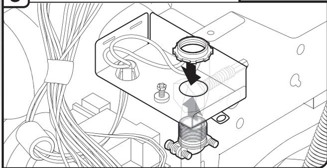
Installer un serre-câble (homologation UL ou CSA). Veiller à ce que les têtes de vis soient orientées vers la gauche après le serrage de l'écrou du serre-câble. Le connecteur de conduit pourrait être fourni avec le cordon d'alimentation.
